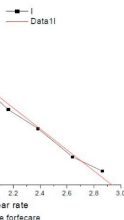
Din valoarea ordonatei la origine rezultă o valoare a viscozității la viteză de forfecare zero de 203,7 mPa.s, de 2,5 ori mai mică decât cea anterioară, ceea ce dovedește că această cremă continuă să fie tixotropă și după ce a fost lăsată în repaus. În plus, se poate să nu fi devenit complet omogenă nici după forfecare îndelungată.
